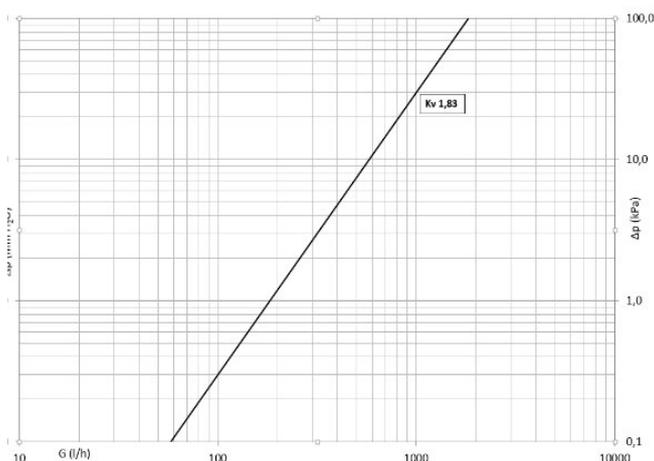
Le diagramme montre les pertes de charge d'un couple de collecteurs 703 \_\_\_ Q ou 704 \_\_\_ Q en considérant une seule sortie Kv=1.83
