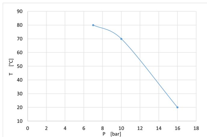
Limite due à l'utilisation de raccords instantanés (queue lisse) avec le collecteur 703 \_\_\_ Q ou 704 \_\_\_ Q
